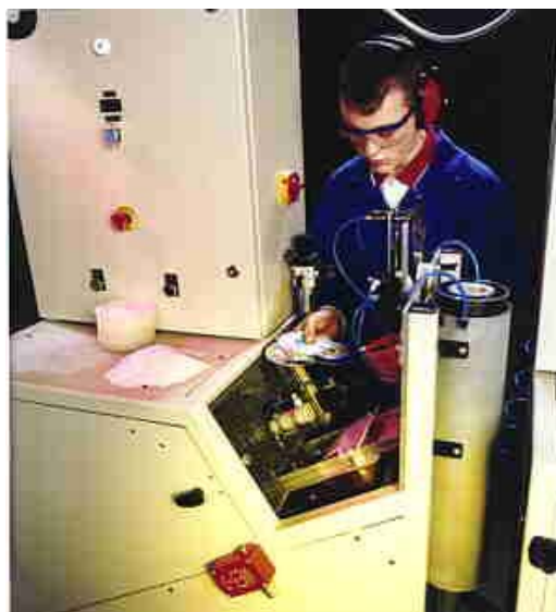
Figure 16 : Machine de séparation pour les CD [©PRL]
